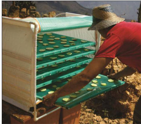
Figura 70. Camara de deshidratado con carga completa
