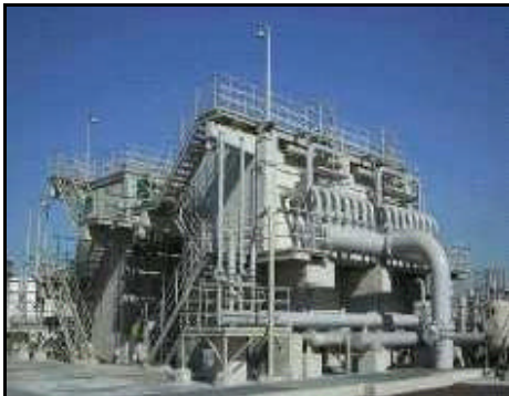
Figura D.13 Vaporizador ORV
