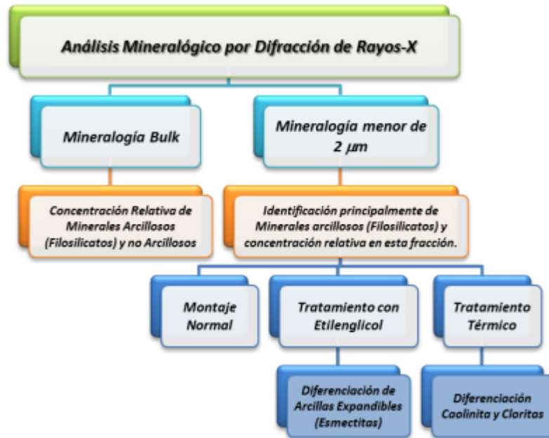
Figura 8. Esquema de Metodología empleada. Procedimiento tomado del Manual de Procedimientos Técnicos del Laboratorio de Procesamiento Geológico, Área de DRX, ECOPETROL-ICP (2015).
