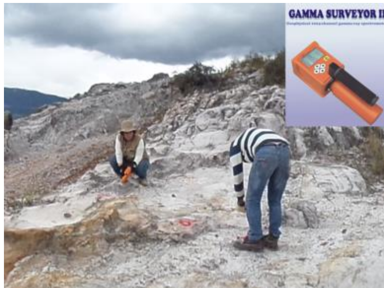
Figura 6. Toma de lecturas de registro Gamma Spectral en afloramiento, con el equipo Gamma Ray Surveyor II, se realizó cada 35 centímetros.
