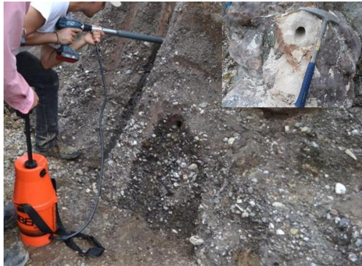
Figura 4. Taladro eléctrico, bomba de inyección de agua y toma de muestras de tapones en afloramiento.
