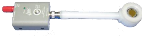
Figura 14. Holder de la QCM con cristal de cuarzo piezoeléctrico.
