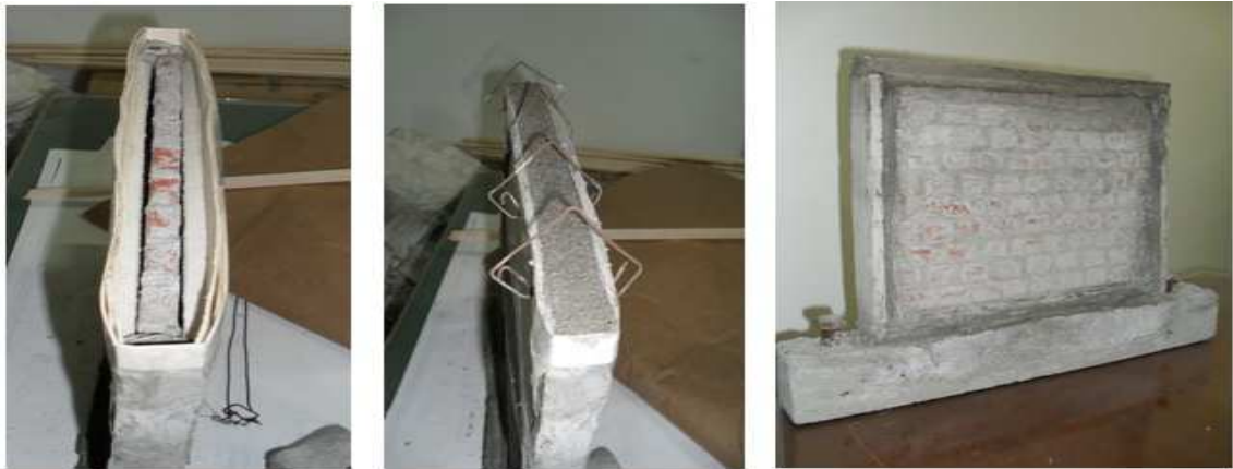
Figura 2. 8 Proceso constructivo de la viga de confinamiento.
