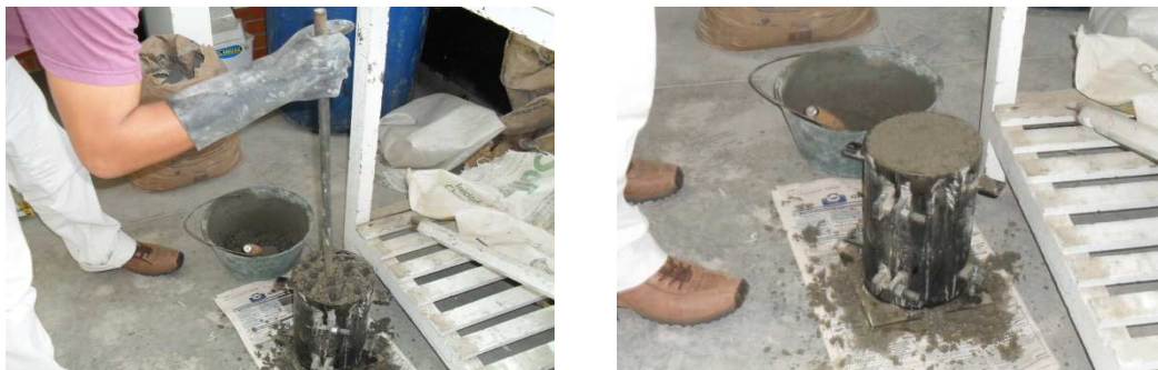
Figura 2. 19 Elaboración y ensayo del cilindro con mortero 1:3
