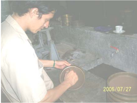
Limpiar perfectamente los tamices del Ro-Tap
