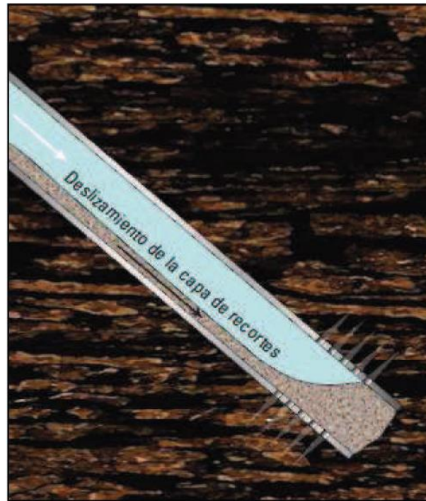
Figura 60. Deslizamiento de la capa de recortes
