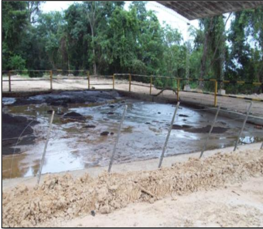
Figura 71. Acumulación de cortes y residuos de perforación.
