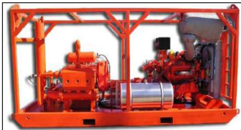
Figura 21. Bomba de inyección de alta presión
