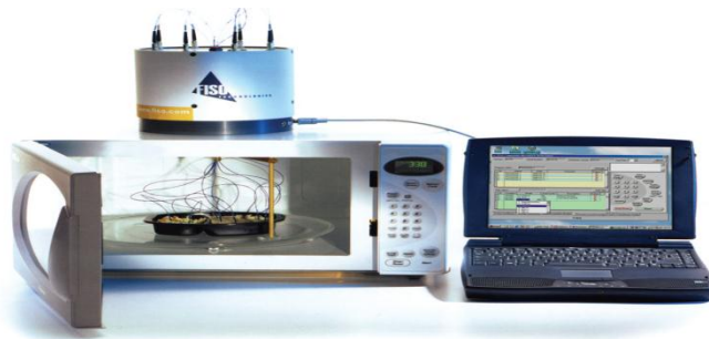
Figura 18. Banco de trabajo para monitoreo de señales en un proceso de microondas
