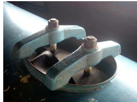
Imagen 1. Compuerta filtro de arena
