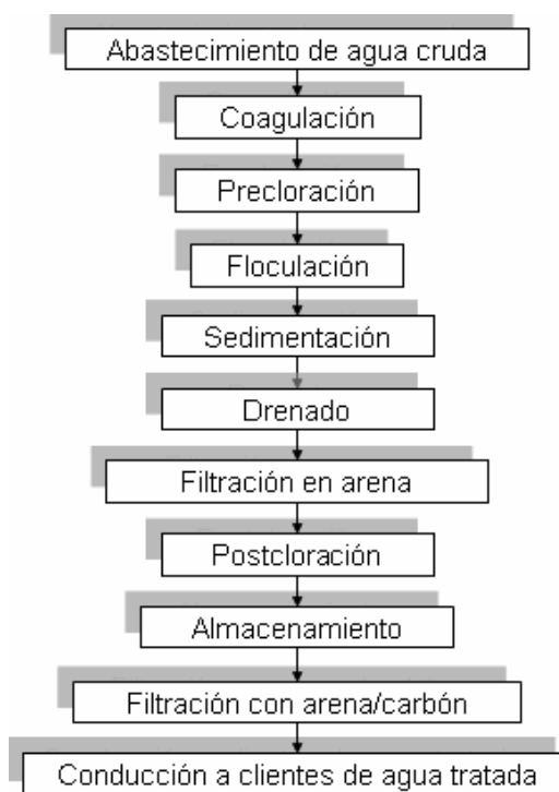
Esquema N° 1. Diagrama de bloques del proceso de tratamiento de agua.
