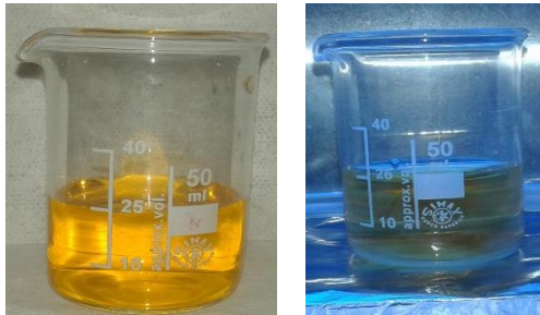
Figura E.9). Soluciones de colorante Oll con 0,2 g/L de rGO@TiO 2 . a). antes de ser expuesta a luz simulada. b). Fin de reacción.
