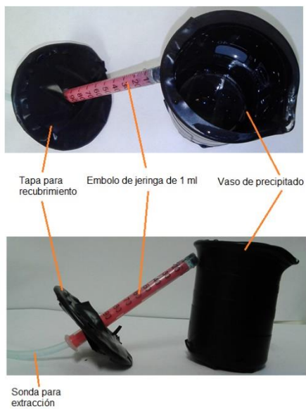
Figura A.1.). Montaje para pruebas de oscuridad. a) Vista superior y b) Vista lateral
