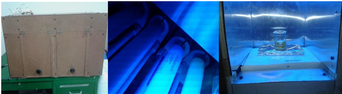
Figura B.2). Reactor de luz simulada UV-Vis. a) vista frontal b) vista interna parte superior c) vista interna
