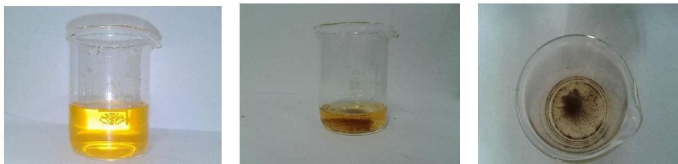
Figura E.7). Soluciones de colorante OII con 0, 2 g/L de rGO@TiO 2 . a). antes de ser expuesta a radiación solar. b). Fin de reacción. c). Prueba de desorción
