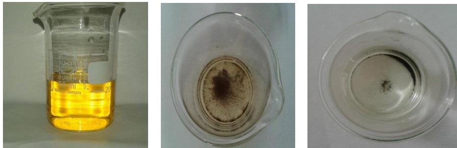
Figura E.10). Soluciones de colorante Oll con 0,4 g/L de rGO@TiO 2 . a). antes de ser expuesta a radiación solar. b). Fin de reacción. c). Prueba de desorción.
