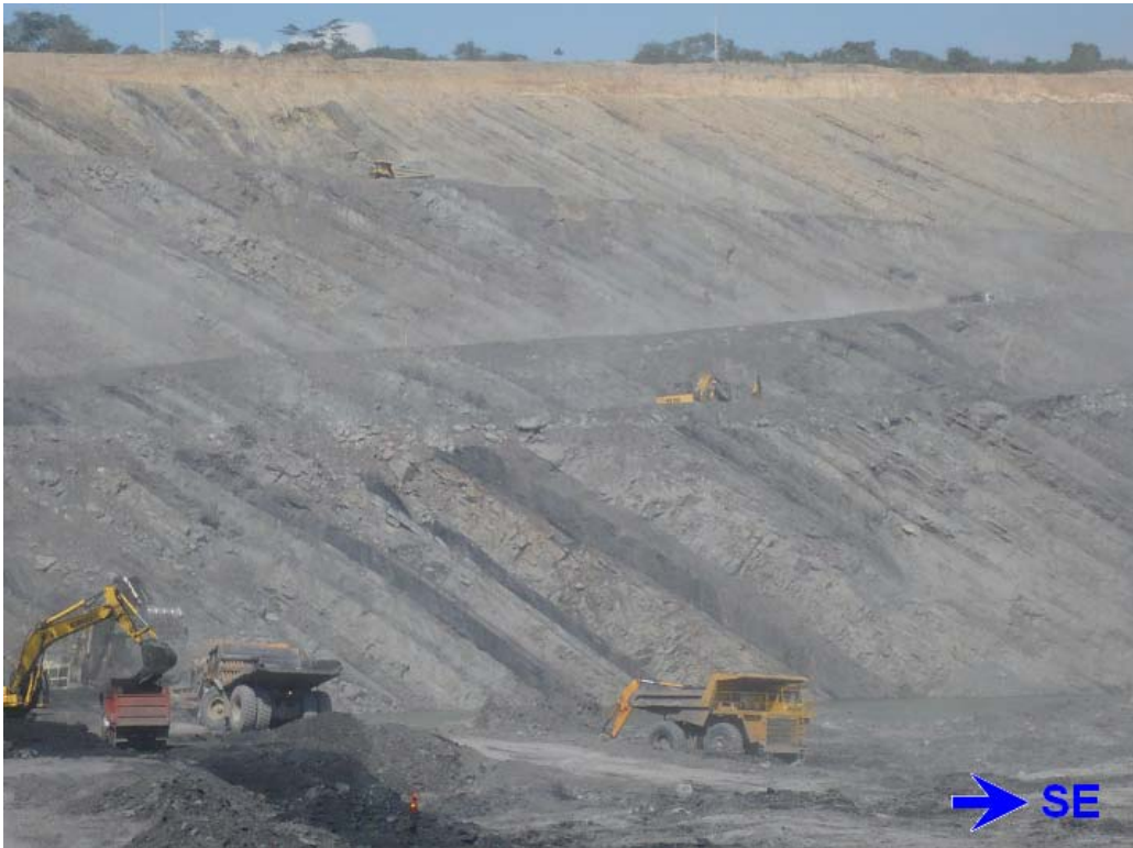
Foto 6. Pared norte del Pit El Hatillo, menor inclinacion de los mantos de carbon, perte hacia el tope del miembro medio de La Fm. Cuervos en direccion SE.
