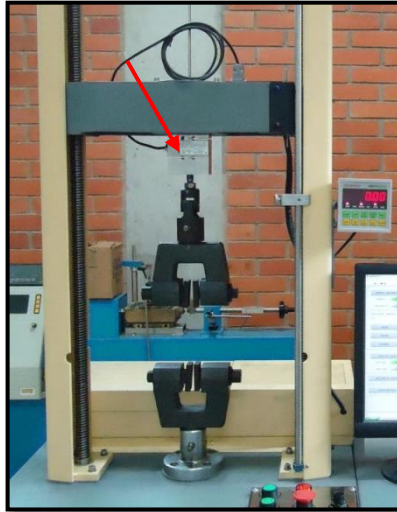
Figura 31. Celda de Carga instalada en la máquina INSTRON 1125. Fuente: Los autores.
