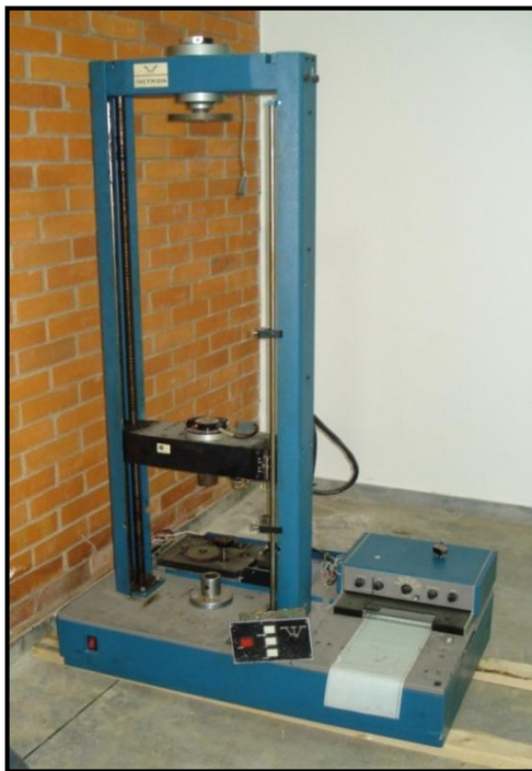
Figura 11. Máquina INSTRON serie 1125 (Estado inicial).
