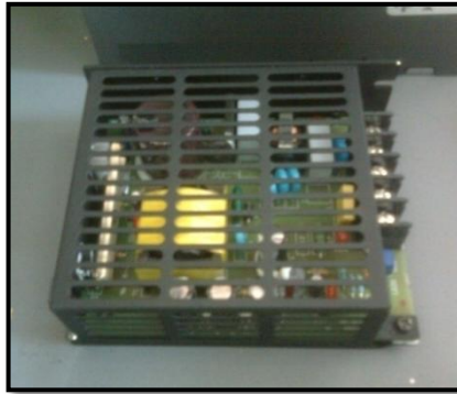
Figura 39. Fuente switchcada de 12 Voltios a 2.5 A Fuente: Los autores
