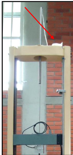
Figura 34. LVDT instalado en la máquina INSTRON 1125.
