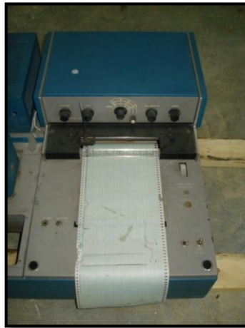
Figura 16. Sistema de adquisición de datos inicial. Fuente: Los Autores.
