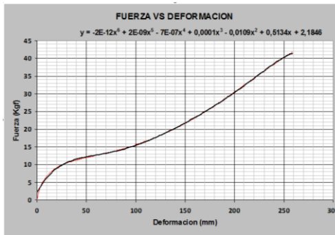
Figura 92. Probeta caucho: gráfica fuerza vs deformación. Fuente: los autores.
