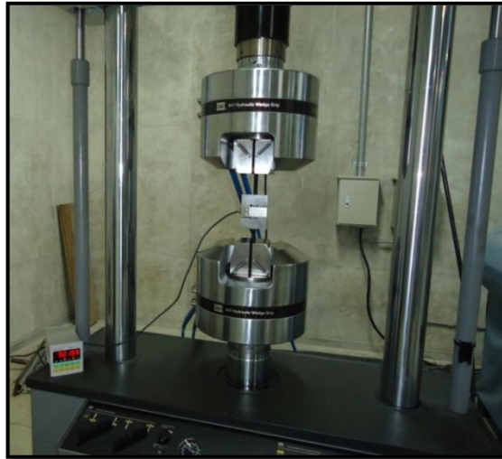
Figura 55. Proceso de calibración de la celda HBM 1500kgf. Fuente: Los autores.
