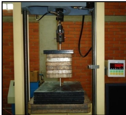
Figura 53. Proceso de calibración de la celda LEXUS 100kgf.
