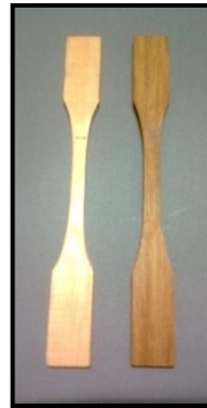
Figura 95. Probetas normalizadas de cedro y zapan. Fuente: Los autores.
