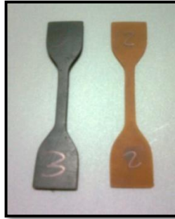
Figura 90. Probetas normalizadas de caucho común y diprene.
