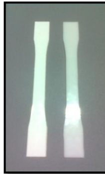
Figura 85. Probetas normalizadas de poliestireno y acrílico.
