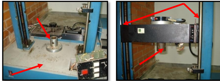
Figura 12. Estructura: a) Base y soporte fijo. B) Vigas laterales y soporte móvil. Fuente: Los Autores.
