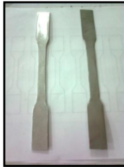
Figura 100. Probetas normalizadas de aluminio y acero inoxidable.
