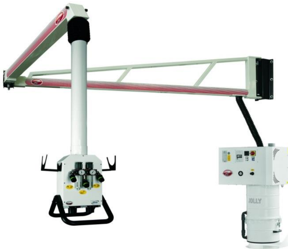
Figura 114. Sistema de aspiración centralizado
