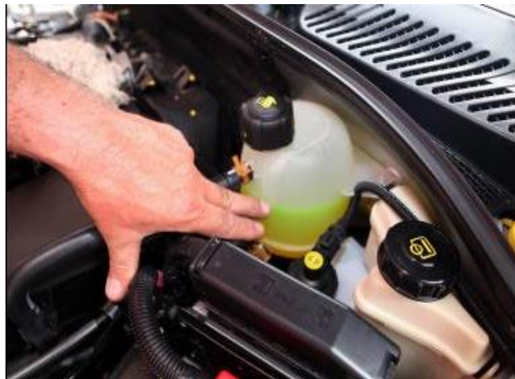
Figura 5. Revisión del nivel de refrigerante
