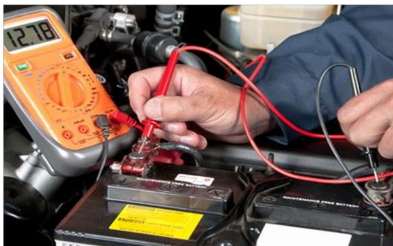
Figura 169. Revisión de batería
