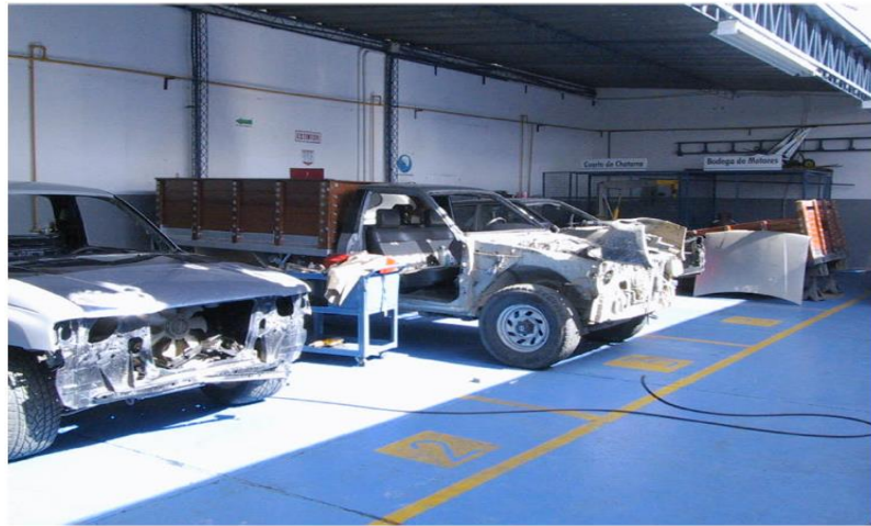
Figura 19. Puesto de desmontaje y reparación
