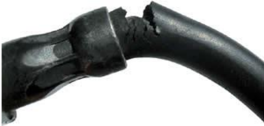
Figura 170. Daño de manguera
