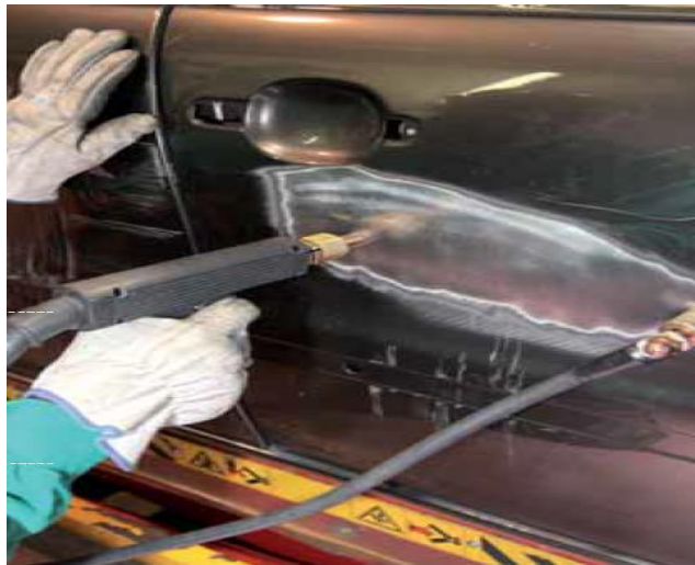
Figura 102. Equipo de recogida de chapa
