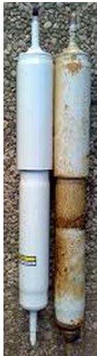
Figura 9. Daño en amortiguador
