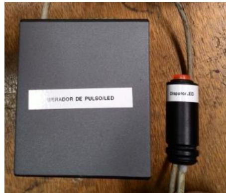
Figura 18. Placa controladora y pulsador.
