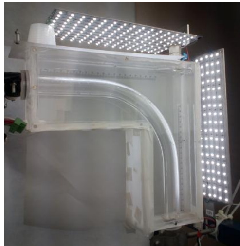
Figura 19. - Montaje paneles laterales
