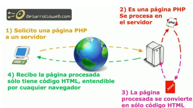
Figura 20. Esquema General de solicitud de una página PHP y su procesamiento en el Servidor.
