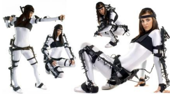
Figura 79. Exoesqueleto electromecánico para captura de movimiento
