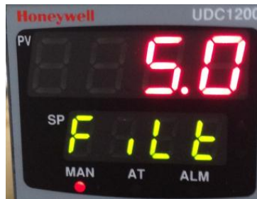
Figura 139. Foto de la pantalla del UDC 1200 en el parámetro constante de tiempo de filtro de entrada
