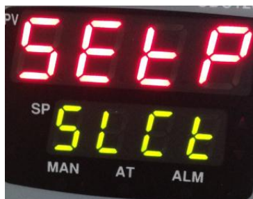
Figura 138. Foto de la pantalla del UDC 1200 en la entrada del modo ajuste.
