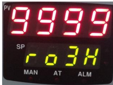
Figura 131. Foto de la pantalla del UDC 1200 en el parámetro retransmisión de la escala del parámetro de salida
