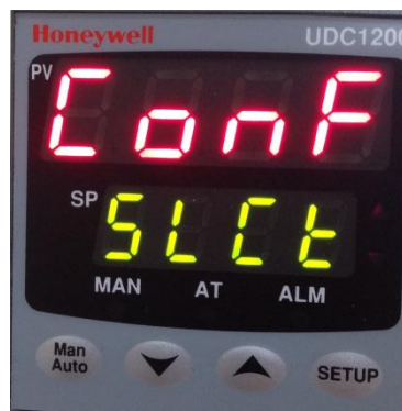
Figura 110. Foto de la pantalla en modo configuración del UDC 1200.
