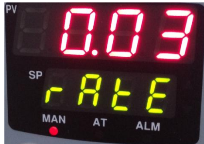
Figura 143. Foto de la pantalla del UDC 1200 en el parámetro constante de tiempo derivativo
