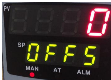
Figura 140. Foto de la pantalla del UDC 1200 en el parámetro Offset de variable de Proceso
