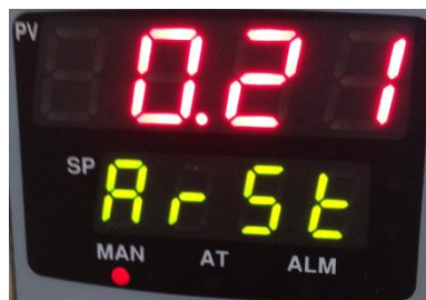
Figura 142. Foto de la pantalla del UDC 1200 en el parámetro constante de tiempo integra
