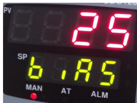
Figura 144. Foto de la pantalla del UDC 1200 en el parámetro Reset manual.
