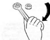
Fig. Comprobación de uniones atornilladas
