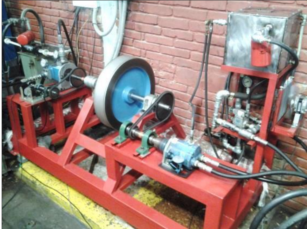
Figura 25. Montaje final de la transmisión en la estructura
