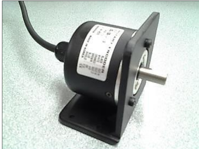
Figura 29. Encoder incremental de 2500 pulsos por revolución
