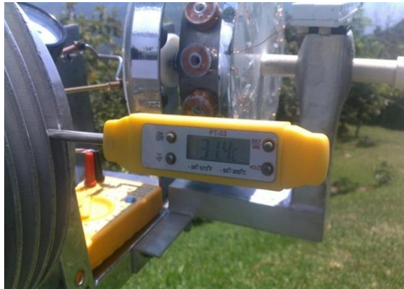
Figura 115. Temperatura inicial en el foco frío
