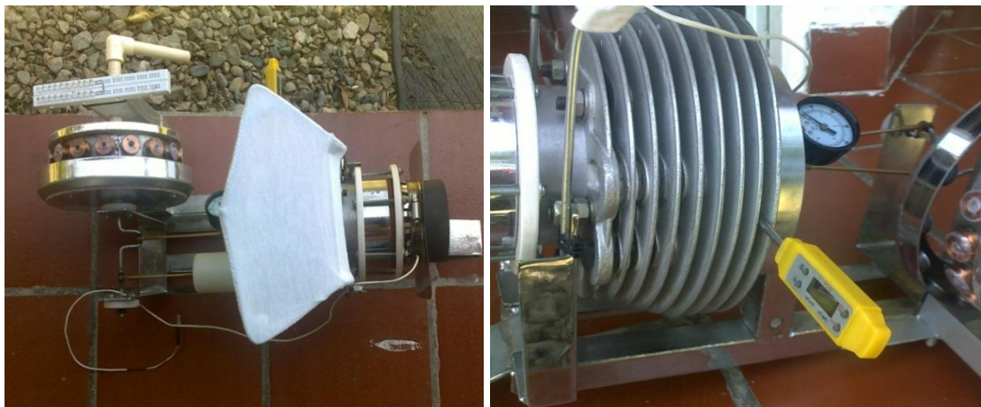
Figura 113. Sensores de temperatura ubicados en el motor Stirling
