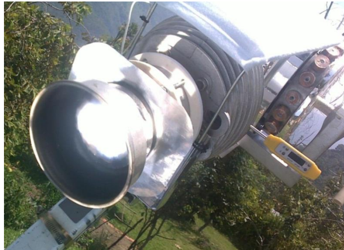
Figura 118. Foco caliente con recipiente para evitar pérdidas de calor por el viento
