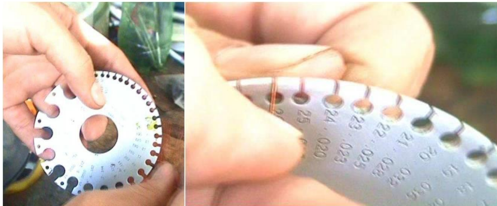
Figura 85. Calibración del hilo de cobre
