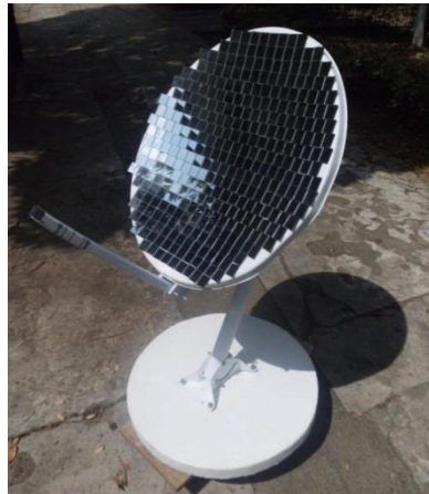
Figura 96. Antena parabólica como concentrador
