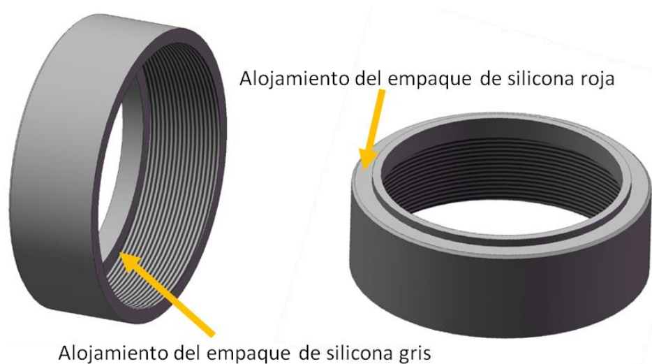
Figura 51. Tapa tuerca con los alojamientos de empaque de silicona
