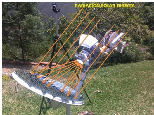
Figura 94. Sistema de captación solar Stirling
