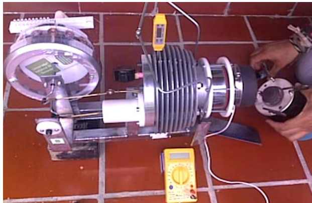
Figura 121. Ubicación de sensores de temperatura en cada zona del motor
