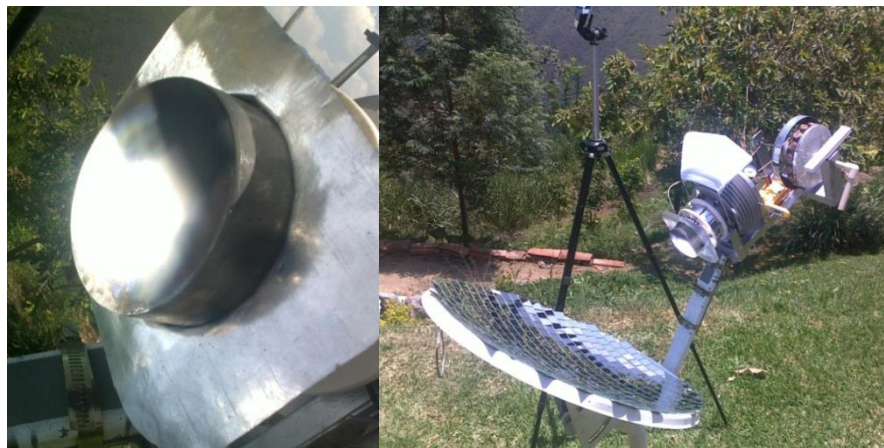
Figura 117. Concentración puntual en el foco caliente
