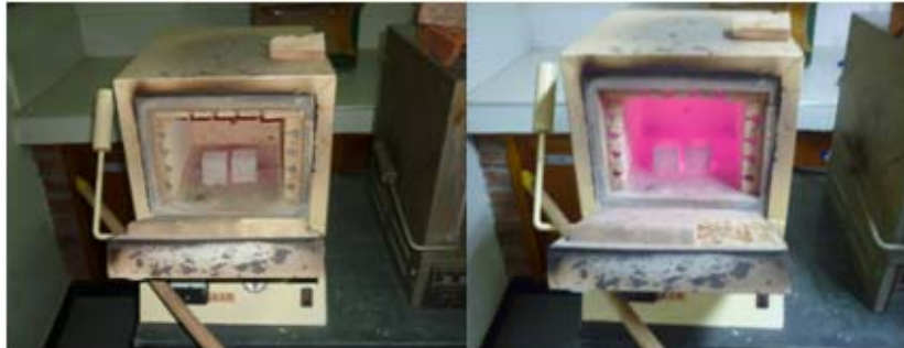
Figura 11. Exposición de los especímenes a altas temperaturas.
