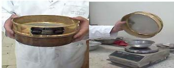
Figura 20. Determinación de la finura del cemento por el tamiz 200
