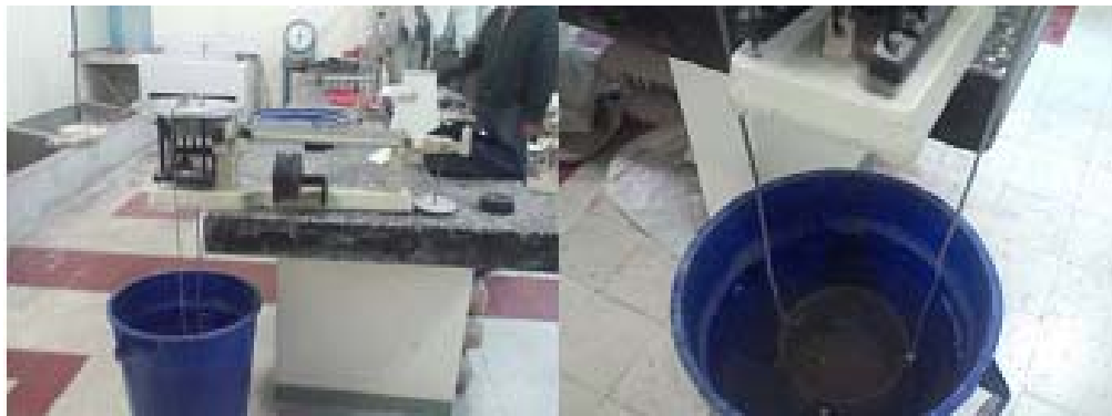
Figura12. Método para determinar la porosidad y densidad
