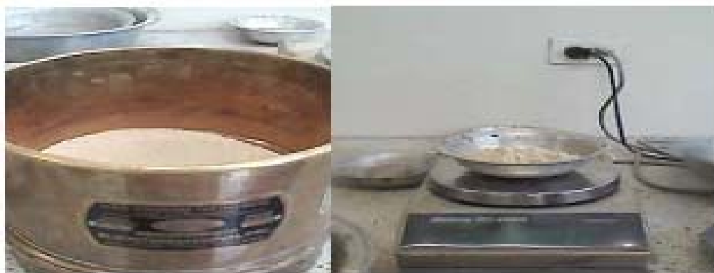
Figura 15. Método de ensayo para determinar la finura de la puzolana
