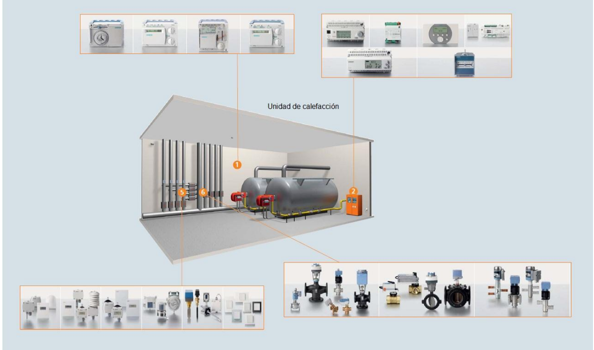
Figura 23. Elementos utilizados en una unidad de calentamiento en un BAS.
