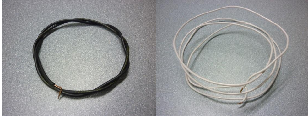
Figura 83. Cable calibre 18AWG y alambre calibre 14AWG
