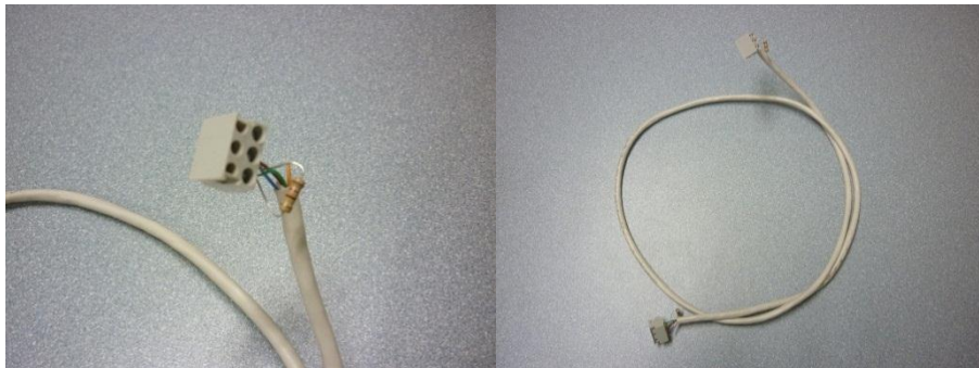
Figura 84. Cable de comunicación MS/TP
