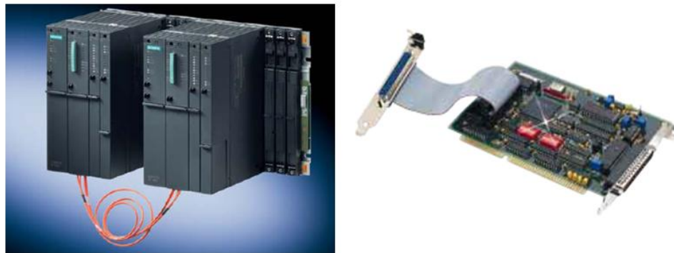
Figura 8. PLC y Tarjeta de Adquisición de Datos. (Siemens y OMEGA).
