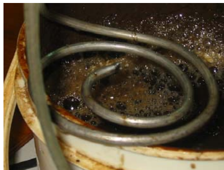
Figura 15. Sistema de Distribución de aire en el reactor de Lodos Activados.
