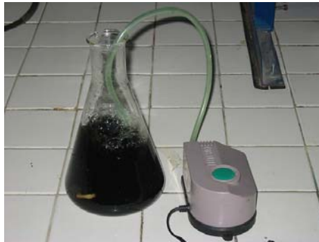
Figura 12. Esquema del reactor empleado en la producción de lodo a partir del lixiviado.
