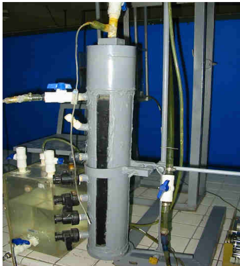
Figura 16. Reactor UASB para el tratamiento de Lixiviado.
