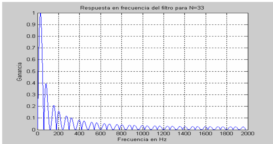
Figura 26. Respuesta en frecuencia del filtrado correspondiente al cálculo del parámetro MAVSAv para una frecuencia de muestreo de 4kHz
