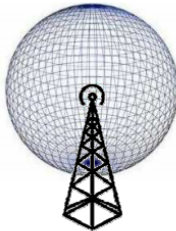
Figura 2.7. Radiación de una antena isotrópica. Tomado de José Antonio, 2017
