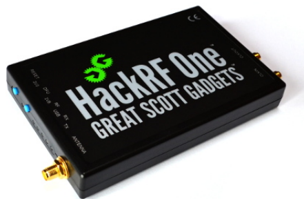
Figura 3.1. Transceptor de radio definido por software Hack RF One. Tomado de Great Scott, 2021
