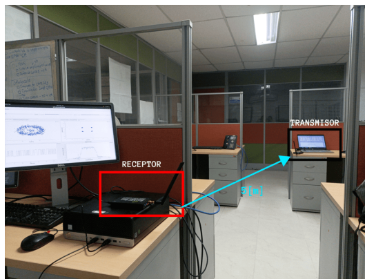
Figura 4.12. Montaje para pruebas del sistema de comunicaciones
