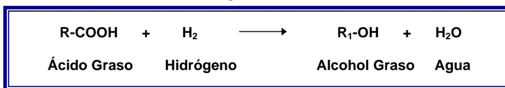
La mayoría de procesos comerciales utilizan temperaturas por encima de 220°C y presiones iguales o mayores a 2.500 KPa. Cuando el proceso se lleva a cabo en lecho fijo, en la práctica se utiliza un catalizador de paladio y cuando se prefiere la operación en lecho suspendido se usa un catalizador de níquel.
