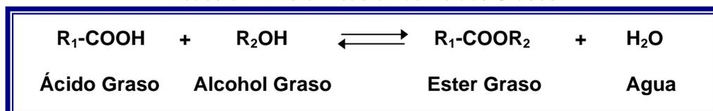
La esterificación ocurre a condiciones de alta temperatura (250°C) y presión atmosférica sin el uso de catalizador.
