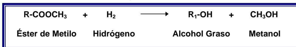
Los ésteres de metilo reaccionan con hidrógeno a alta presión en presencia de un catalizador para producir alcoholes grasos y metanol como se muestra en la Reacción 8.
