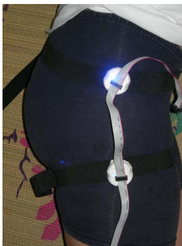
Figura 4.19: Instalación de las UMA en el cadera
