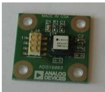
Figura 4.9: Fotografía de la tarjeta de evaluación del ADIS16003
