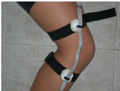
Figura 4.18: Instalación de las UMA en el rodilla
