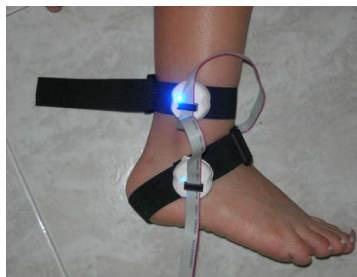
Figura 4.17: Instalación de las UMA en el tobillo
