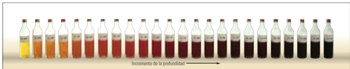
Figura 14. Muestras de petróleo crudo extraídas de una sola columna de petróleo en un yacimiento.
