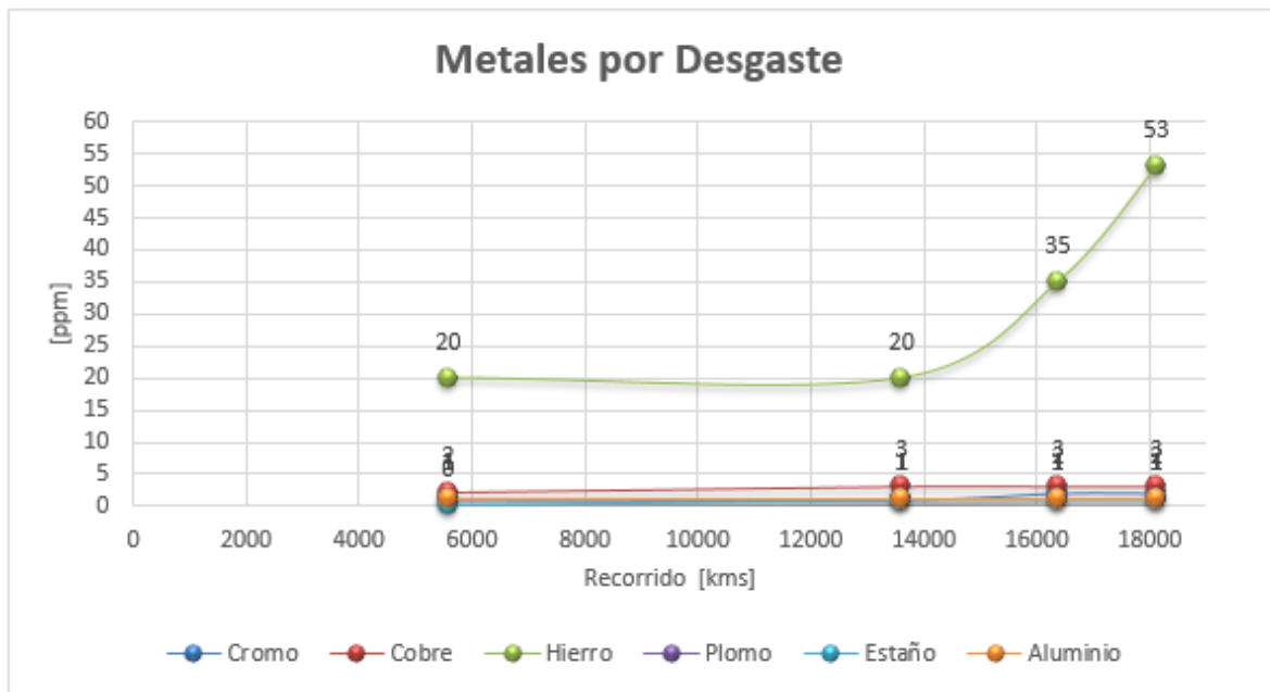
Figura 19. Concentración de metales por desgaste
