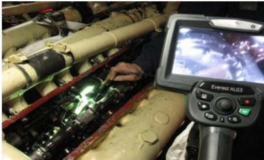
Figura 7. Endoscopia realizada a un motor marino
