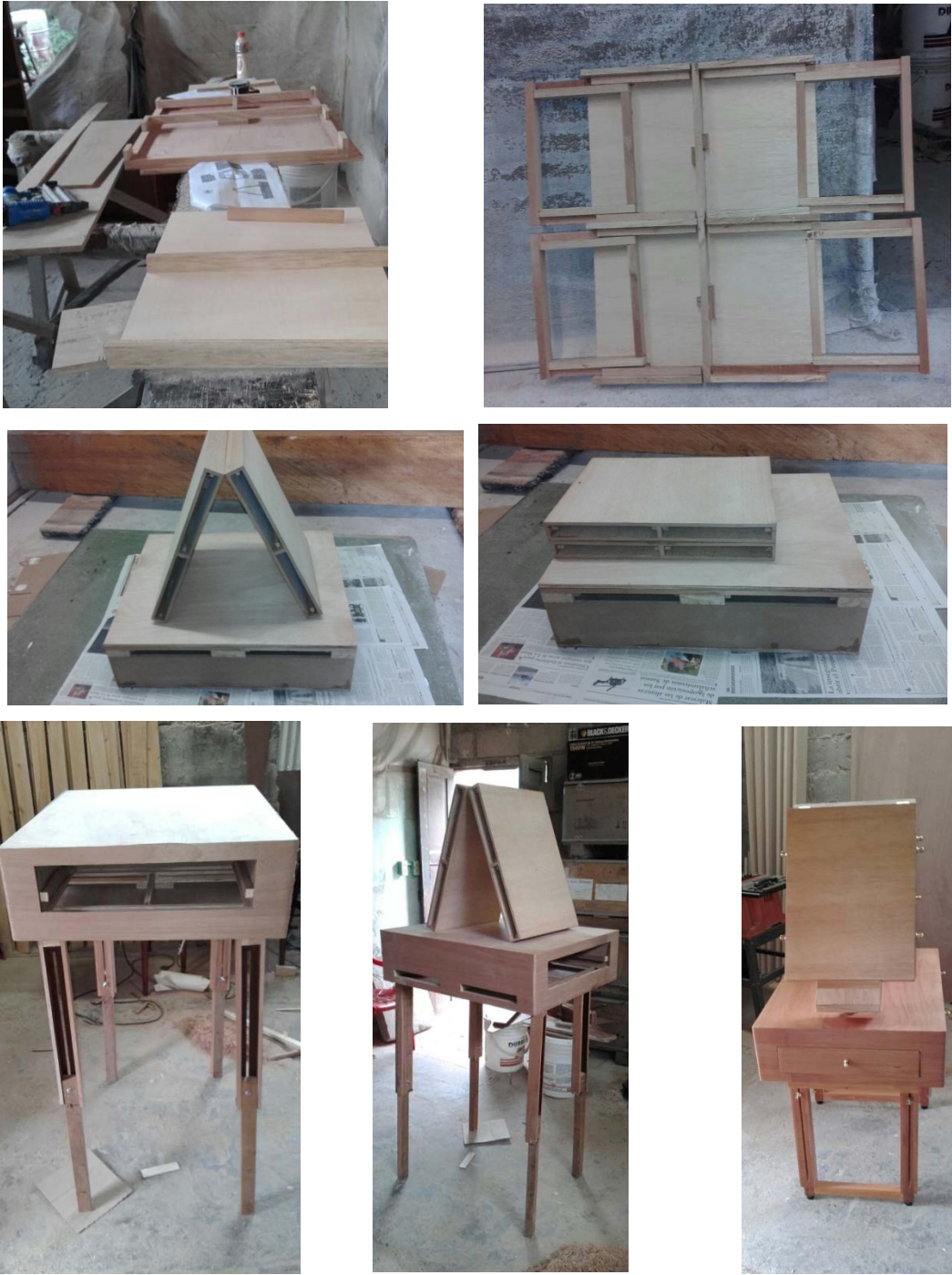
Figura 10. Construcción del primer prototipo en madera.
