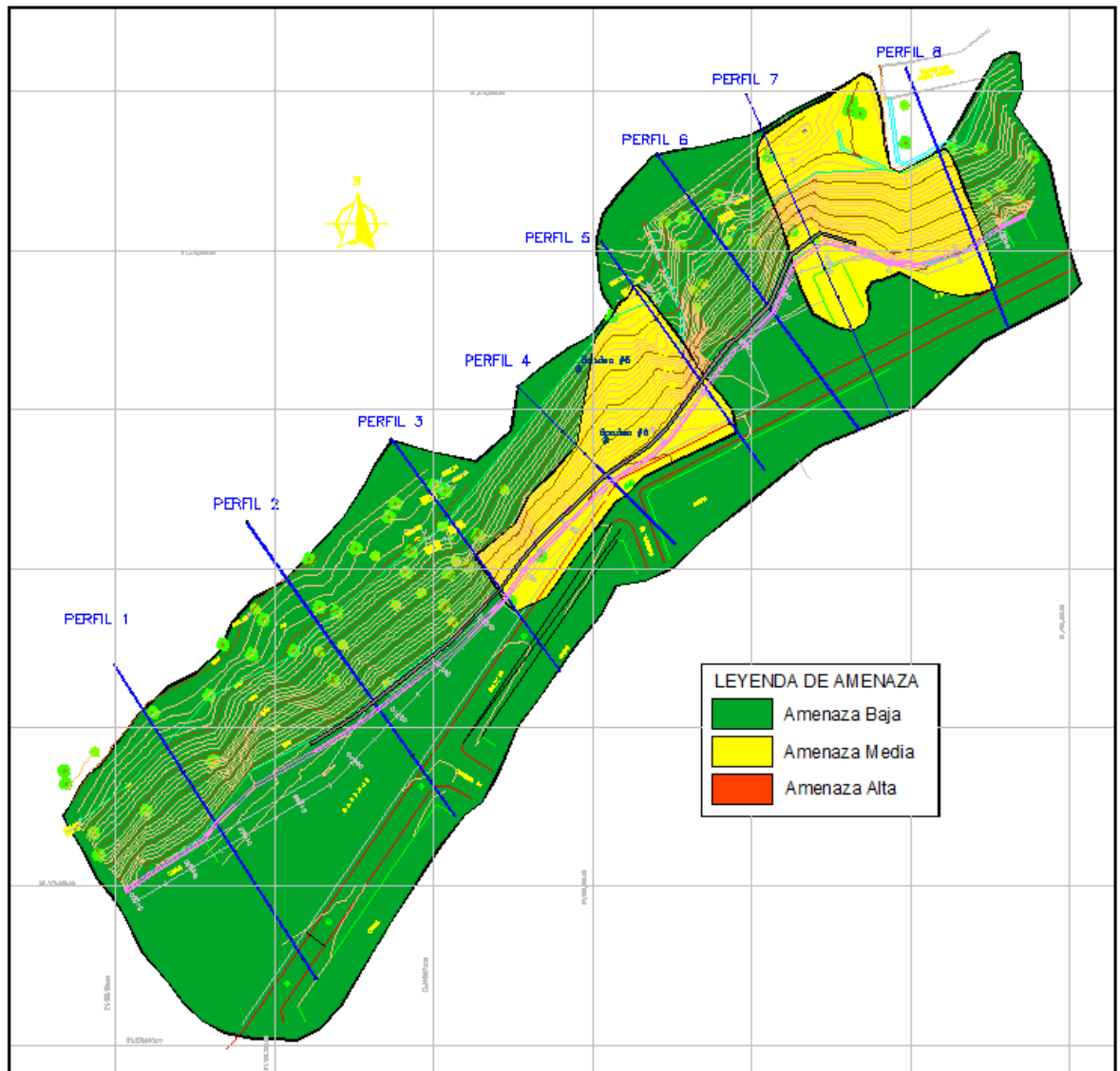
Mapa de Análisis de estabilidad para todos los perfiles, Condición Estática con Obras de Mitigación Propuestas.
