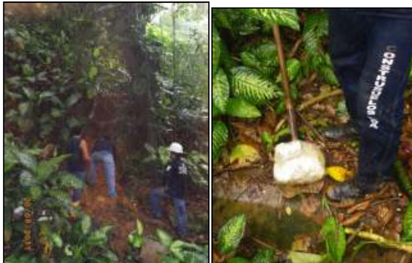
Ilustración 17. Ejecución Apique 2. Parte media del talud
