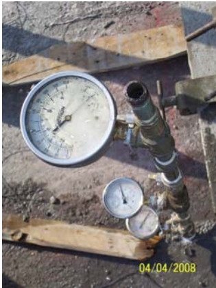
Figura 20. Flauta para ejercer calibración manómetros.
