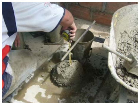
Figura 37. Medición del Asentamiento.
