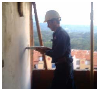
Figura 61. Uso del esclerómetro.
