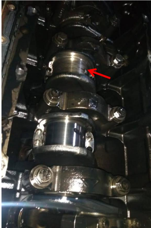
Figura 40. Desgaste excesivo muñon de biela cigüeñal del piston #5 vista posterior.
