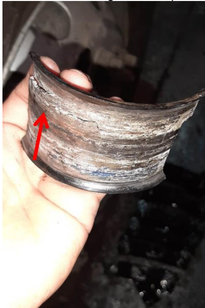
Figura 48. Deterioro grave casquete inferior de bancada cigüeñal del pistón #1.
