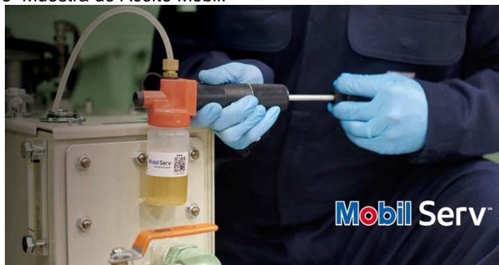
Figura 11. Toma de Muestra de Aceite Mobil.
