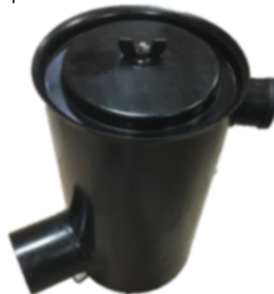
Figura 62. Base Filtro Antiguo y deteriorado visto posterior
