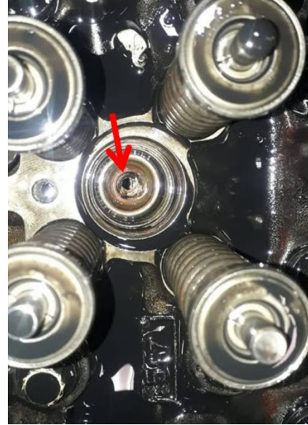
Figura 37. Alojamiento de Tobera Inyector #5 fragmentado.
