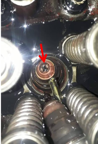
Figura 36. Tobera Inyector #5 fragmentado.
