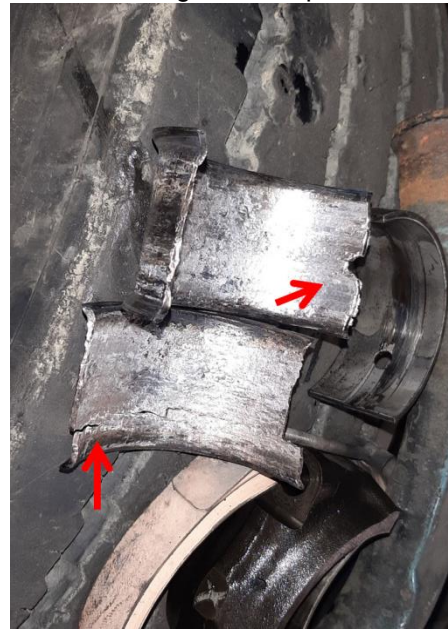
Figura 49. Deterioro grave casquete superior de bancada cigüeñal del pistón #1.
