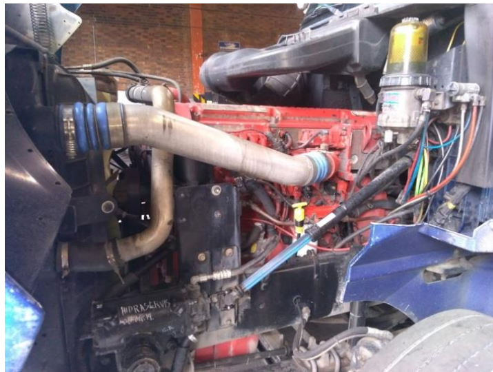
Figura 6. Fotografía Motor Cummins ISX UEN EDINSA - POSTOBON .
