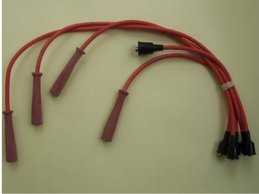
Figura 140 Cables de alta tensión.†
