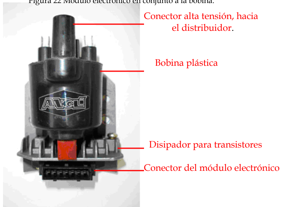
Figura 22 Módulo electrónico en conjunto a la bobina.*
