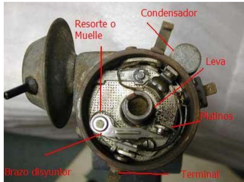
Figura 7 Elementos del distribuidor*
