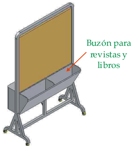
Figura 118 Parte posterior estructura de tubo cuadrado.*
