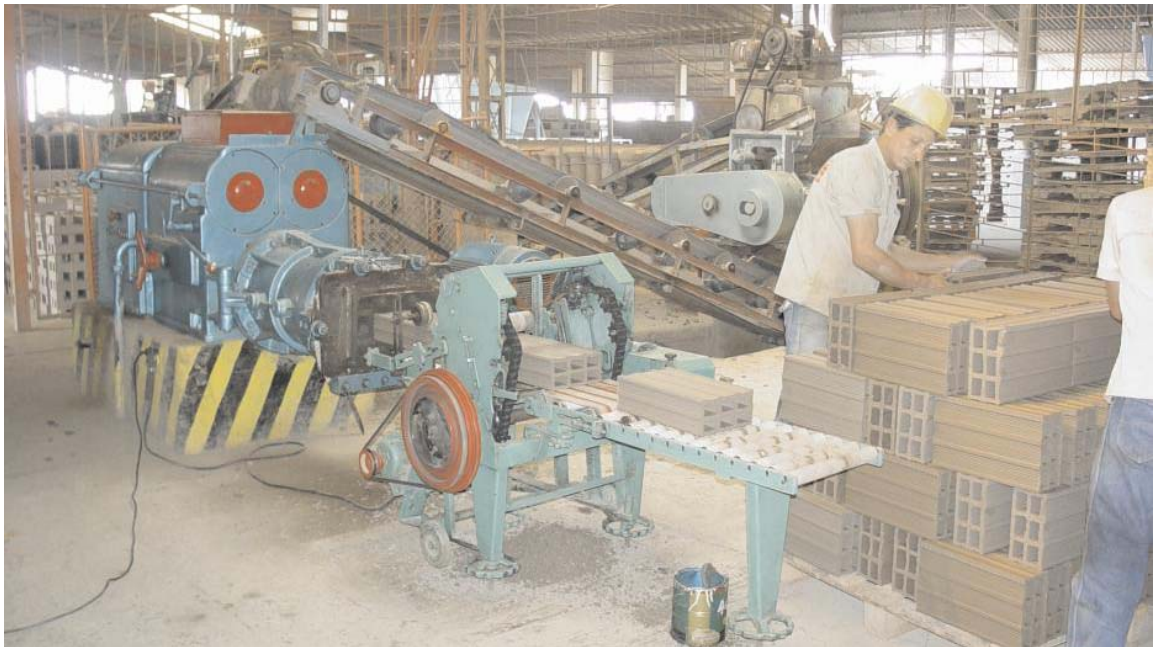
Figura 23. Proceso de corte para ladrillo H10.
