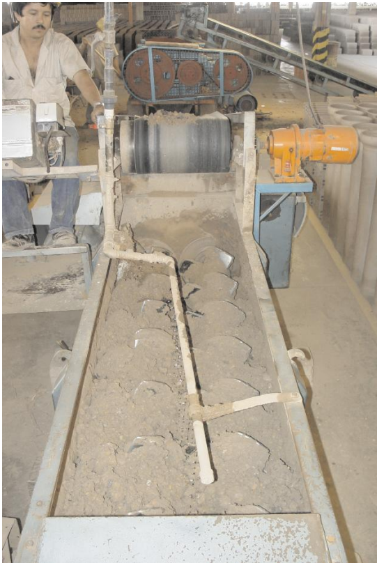
Figura 20. Cajón amasador (homogenización).
