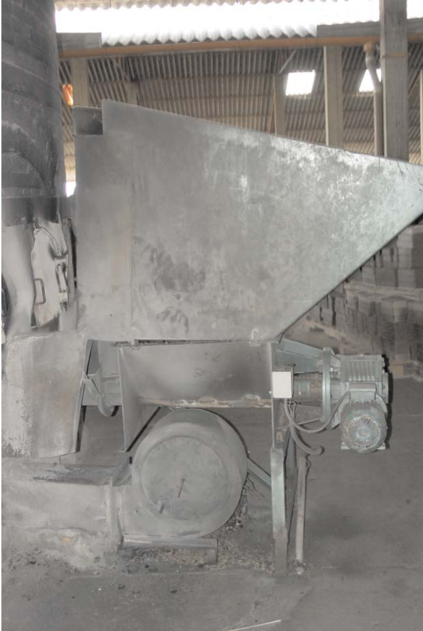
Figura 30. Horno con stockers de alimentación.
