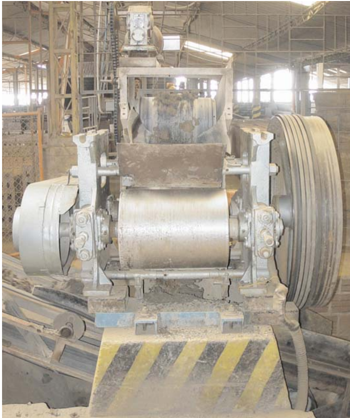
Figura 21. Molino laminador (molienda secundaria).
