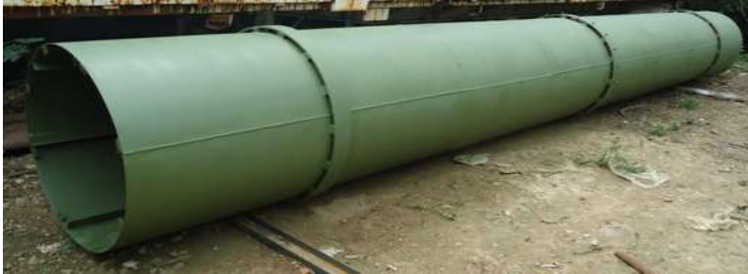
Figura 11. Soldadura terminada de la carcasa del horno
