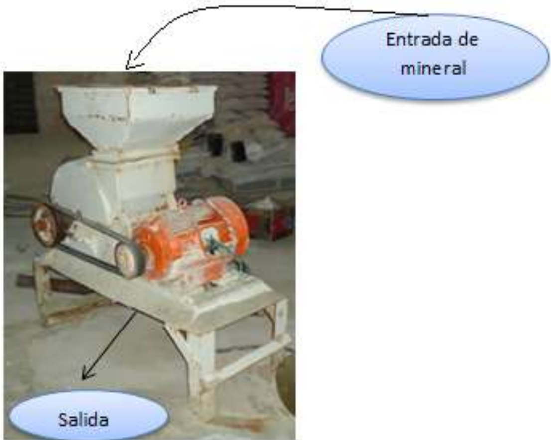
Figura 4. Entrada y salida del material a través del molino de martillos
