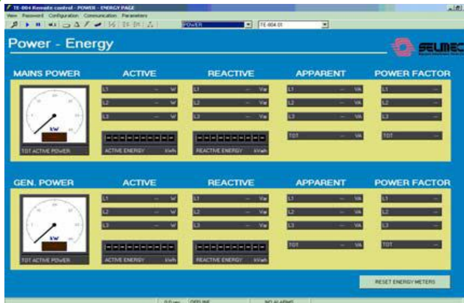
Figura 1.9 Pantalla de visualización de potencias y energías en la PE
