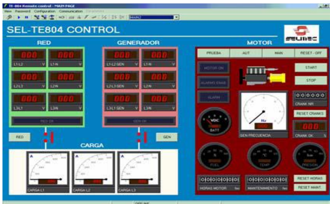
Figura 1.8 Pantalla de visualización, parámetros generador y motor
