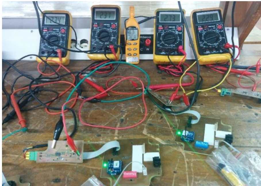
Figura 23. Visualización lecturas de voltaje a la salida de las RTD's (Multímetros)
