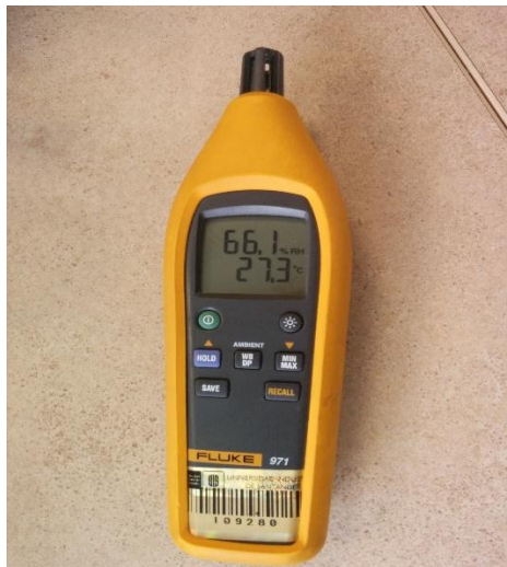
Figura 25: NODO 1 Visualización de humedad 66,1 %RH (medidor de temperatura y humedad)
