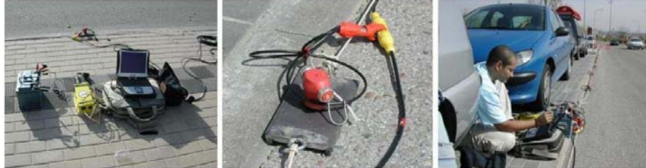
Figura 25. Instrumentación y geófonos de 4,5 Hz sobre placa metálica para aplicación urbana
