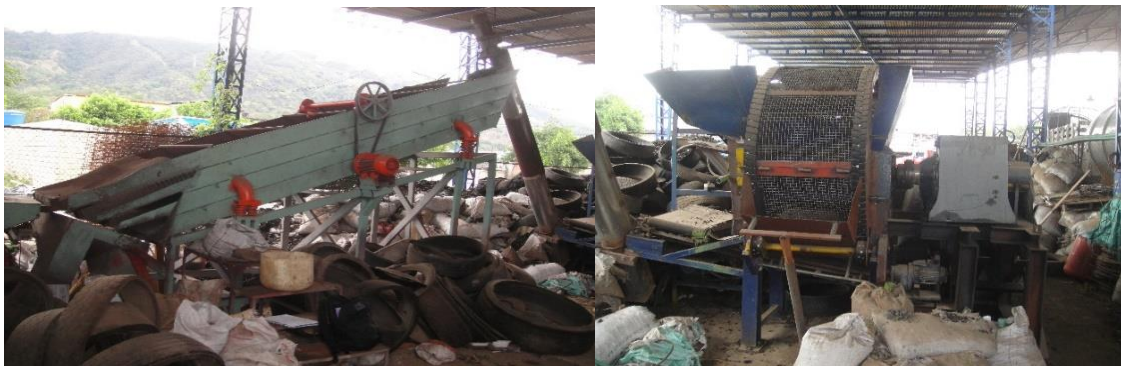
Figura 2. Equipos de trituración y clasificación. a) zaranda b) triturador primario.
