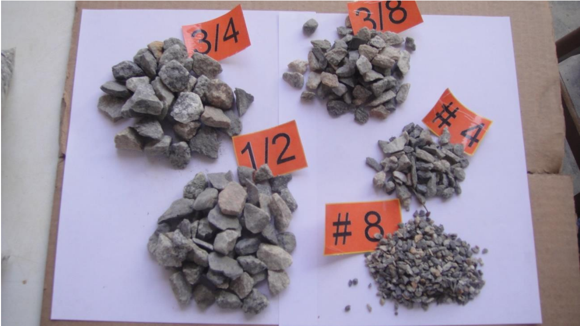
Figura 13. Gradación agregado grueso y fino natural.
