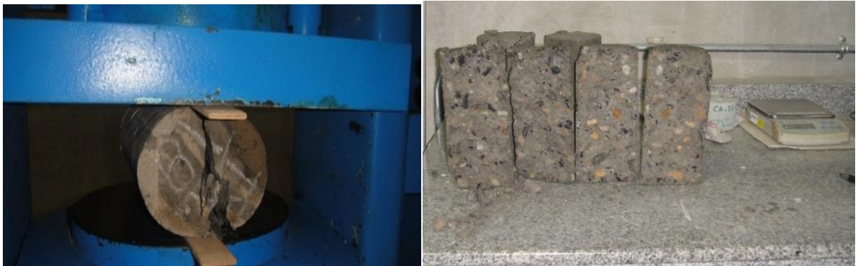
Figura 8. Especímenes fallados a tracción indirecta.
