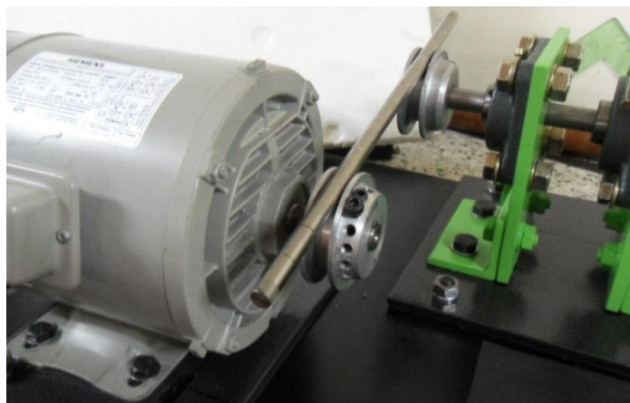
Figura 105. Alineación de las poleas
