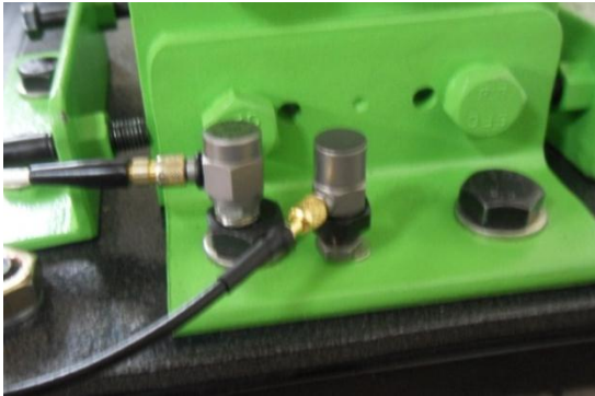
Figura 108. Ubicación de sensores - Soltura mecánica
