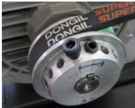
Figura 113. Excentricidad inducida en polea por masa agregada
