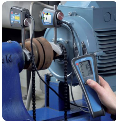
Figura 40. Montaje del alineador laser
