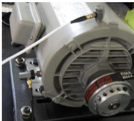
Figura 114. Ubicación de sensores - Excentricidad en polea
