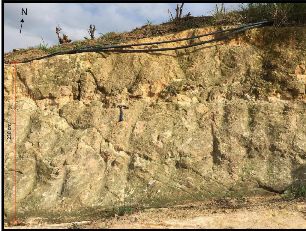
Figura 21. Afloramiento correspondiente a la muestra DH-003. Se evidencia alto fracturamiento.
