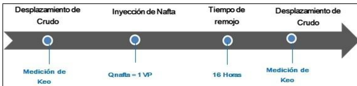
Figura 35. Procedimiento de evaluación de daño a la formación.
