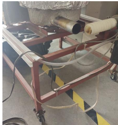
Figura 55. Estructura del quemador ciclónico.
