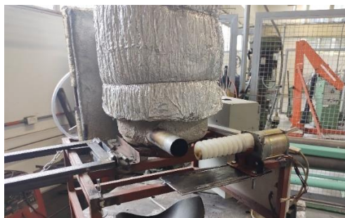
Figura 56. Instalación de base para reclinar la cámara y guía del tornillo.
