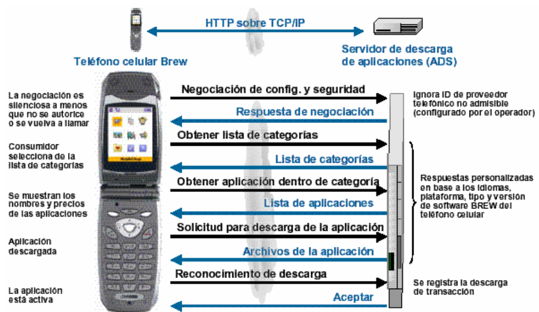
Figura 6. Negociación entre el dispositivo y el servidor ADS
