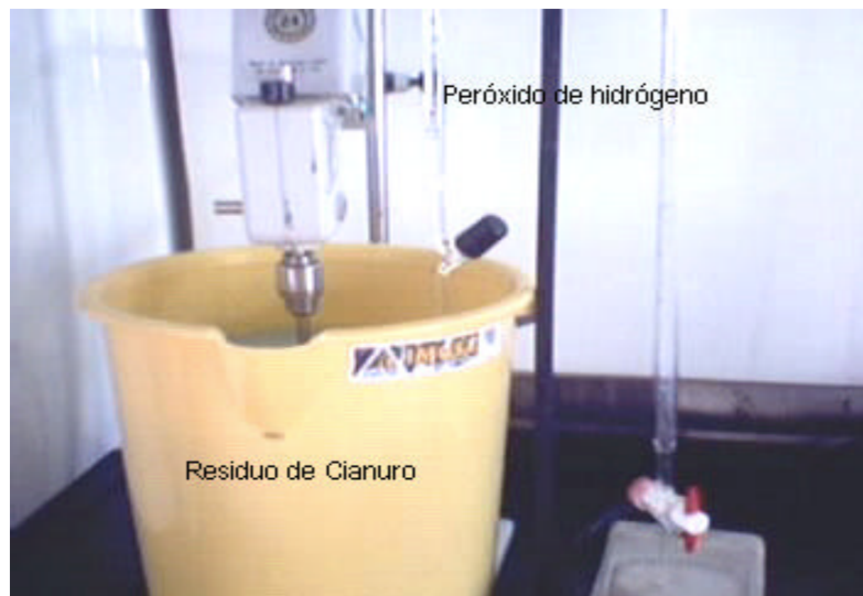
Figura 6. Montaje empleado para el tratamiento de cianuro
