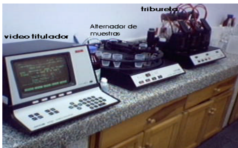
Figura 4. Equipo utilizado para realizar .las mediciones de EIS
