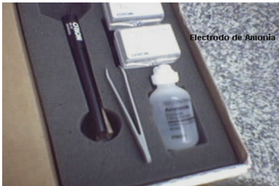
Figura 3. Sistema combinado de medición EIS, con un solo electrodo (electrodo de amonio)
