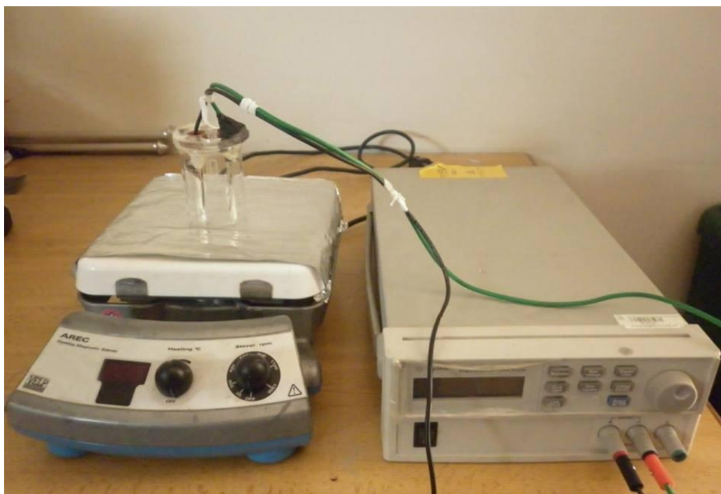
Figura 12. Montaje experimental de anodización electroquímica.
