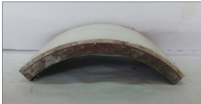
Figura 3. Muestra de acero al carbono con recubrimiento tricapa para ensayos de corrosión.
