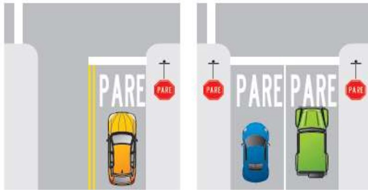
Figura 14. Demarcacion PARE. Tomado De Ministerio de Transporte. (2015). Manual de señalización vial. Bogotá D.C.: Diseñum Tremens
